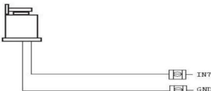
安装接线完毕后，我们就可以来调试对刀功能了，对刀的开始是在“MDI”方式下输入“M930”执行的，“M930”是内在调试好的宏程序。首先我们在MACH3软件“OFFSETS”（偏移设定）画面下，在“TOOL CHANGE LOCATION”（换刀位置）输入您的对刀器位置。如下图：
